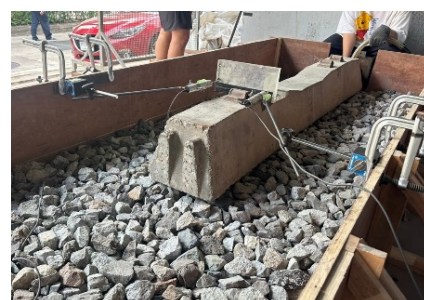
รูปที่ 8 ทดสอบกับหมอนรองคอนกรีต
