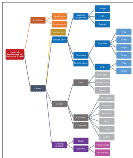
รูปที่ 2 แผนภูมิแสดงปัจจัยที่ส่งผลต่อแรง Lateral resistance (Guoqing Jing and Peyman Aela, 2019)
